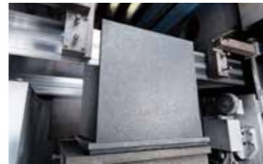
電着バンドソーによる硬質カーボン切断 Hard carbon cutting with electroplated band saw
